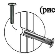
(рис. №6) После установки всех секций наместо и их выравнивания сверлятся отверстия Ø8мм. и корпуса стягиваются между собой межсекционной стяжкой.
